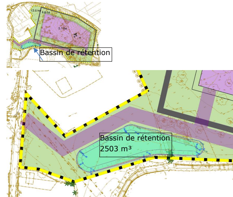
Figure 133 : Localisation envisagée du bassin de rétention / infiltration
